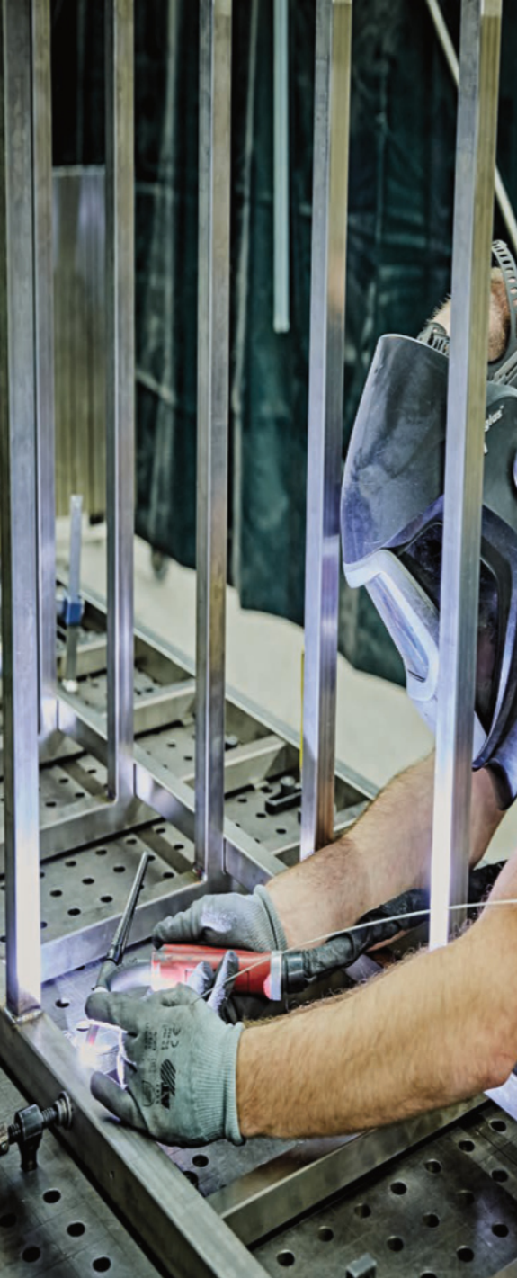
Abb. Baugruppenfertigung aus Edelstahl (WIG)
