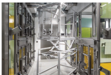
Abb. Spezieller Fang- oder Applikationskäfig zum Überführen von Einzeltieren
