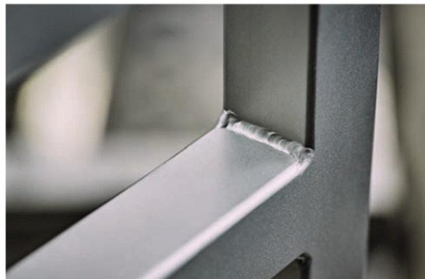
Abb. Saubere korrosions- beständige Schweißnähte (WIG)
