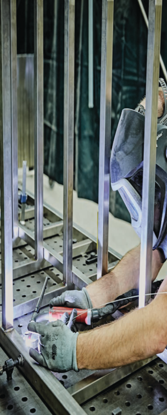
Abb. Baugruppenfertigung aus Edelstahl (WIG)
