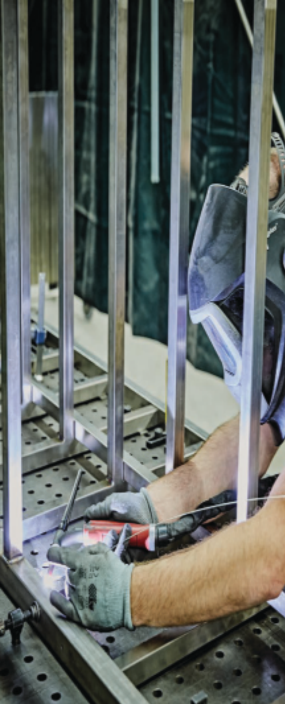
Abb. Baugruppenfertigung aus Edelstahl (WIG)
