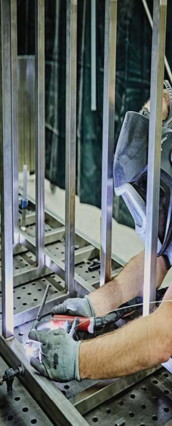
Abb. Baugruppenfertigung aus Edelstahl (WIG)
